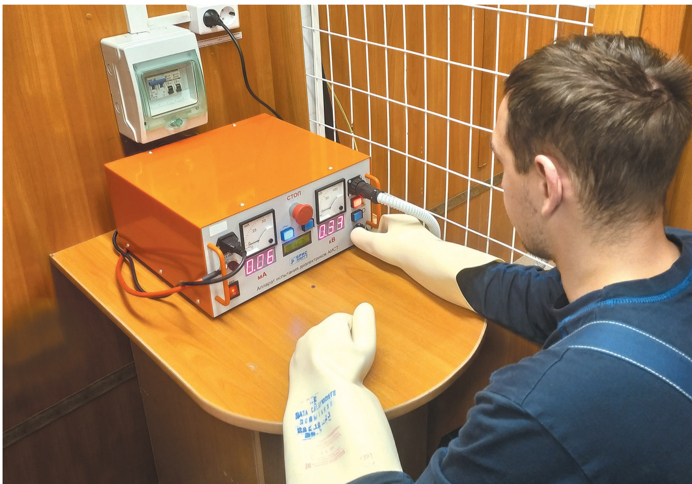
Испытание средств защиты от поражения электрическим током – одна из задач Электротехнической лаборатории ООО «БНГРЭ»
