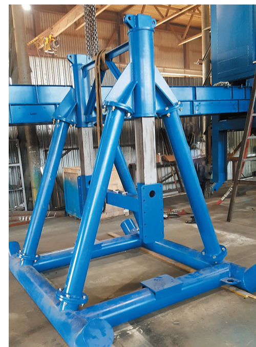
Выдвижная опора наружной секции ленточного транспортера
